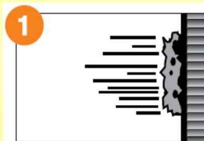
1 圧縮空気で飛ばされたスポンジメディアが対象物にぶつかることでスポンジがつぶれ、中の研掃材が飛び出し、表面を処理します。
