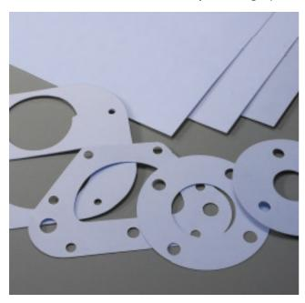
ECS-Tは強薬液にご使用いただける、FDA基準に 適合したPTFEベースのシートガスケットです。 水、蒸気、炭化水素、過酸化水素、溶剤、冷却剤、 低温流体、苛性、強酸などにご使用いただけます。
