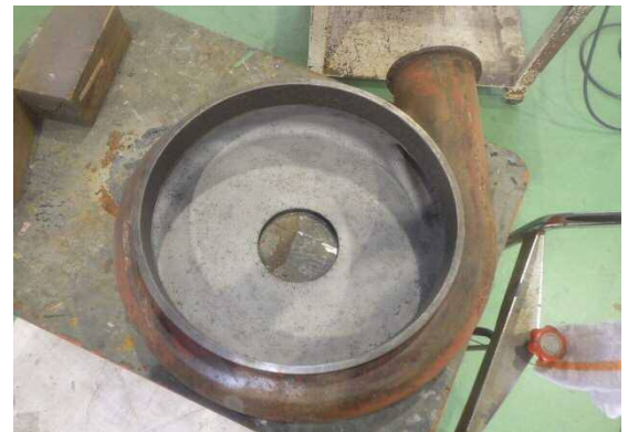
②スポンジブラスト施工
