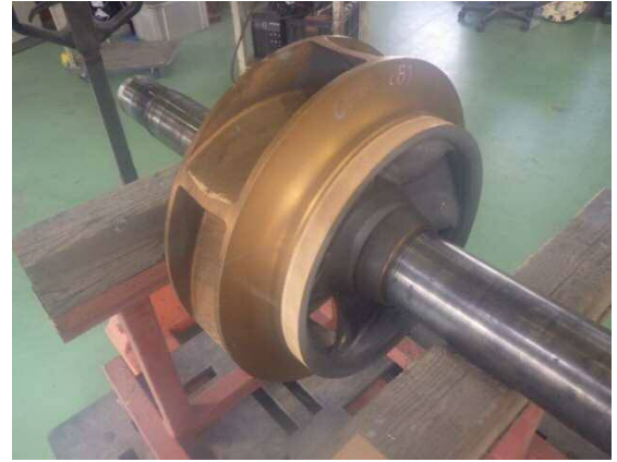
②スポンジブラスト施工
