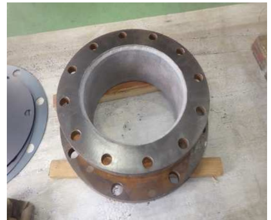
②スポンジブラスト施工
